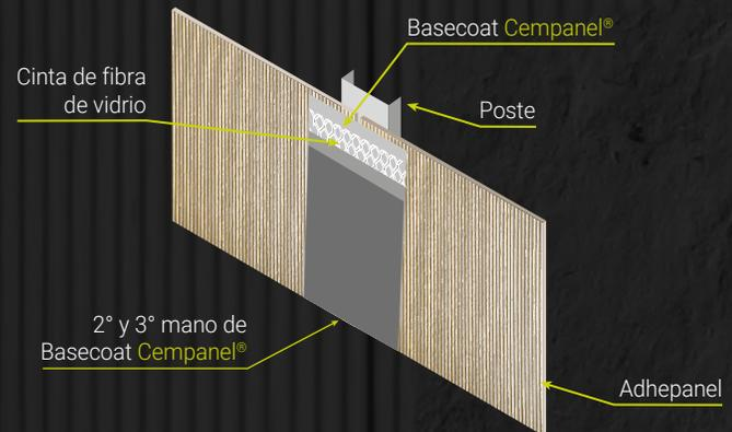
Dependiendo del peso del recubrimiento se deberá revisar si es necesario hacer fijaciones mecánicas además de adhesivo según el acabado.
